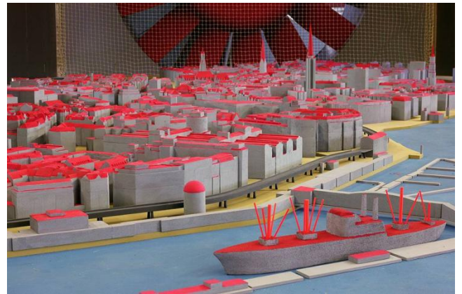
Bild 3: Hamburg-Modell im Grenzschicht-Windkanal des Meteorologischen Instituts der Universität Hamburg
