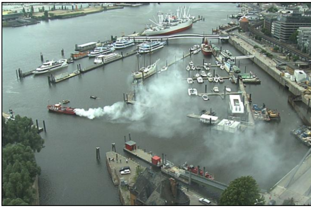
Bild 4: Mit Rauch durchgeführte Ausbreitungsversuche im Hamburger Hafen
