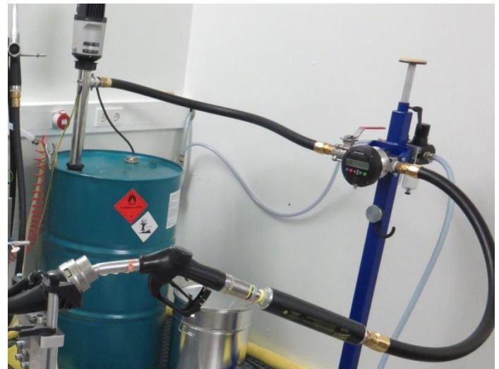
Bild 1 : Befüllvorrichtung zur Ermittlung der elektrostatischen Aufladung beim Betanken
