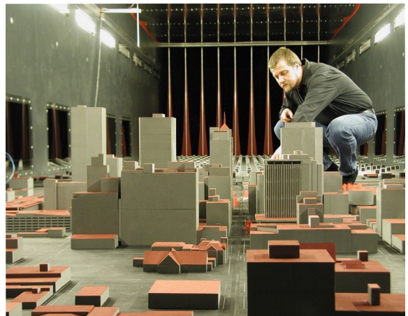
Bild 2: Experimente zur Modellvalidierung im Windkanallabor der Universität Hamburg
